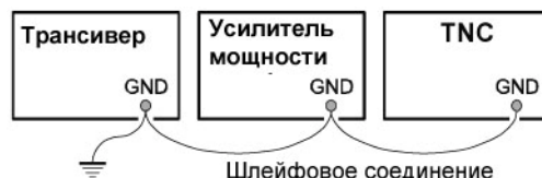
Неправильное подключение заземления
