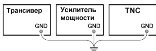
Правильное подключение заземления
